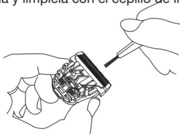
3. Deslice el botón de ajuste de longitud de corte hacia adelante para levantar la cuchilla movediza, y luego límpie el espacio entre la cuchilla fija y la cuchilla movediza.
