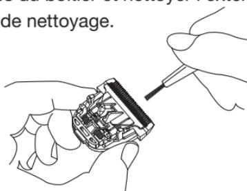
3. Faire glisser le bouton de réglage de la hauteur de coupe vers l'avant pour remonter la lame mobile, puis nettoyer l'espace entre la lame fixe et la lame mobile.
